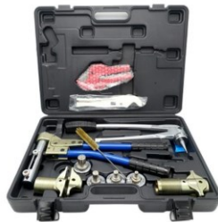
Механічний інструмент V&G для систем натяжних кілець VG-511652
