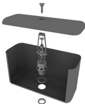
Схема установки системи зливу в змивний бачок
